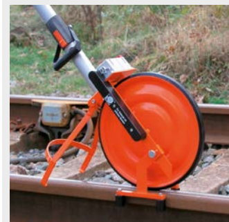
M10 Messrad mit Schienenführung Roue d'arpenteur M10 avec guidage pour rails
